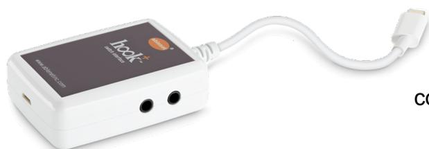
Le **Hook+** est un boîtier à connecter à votre appareil iOS via son entrée Lightning et offrant la possibilité d'y brancher jusqu'à 4 contacteurs. Vendu par *Ablenet*
